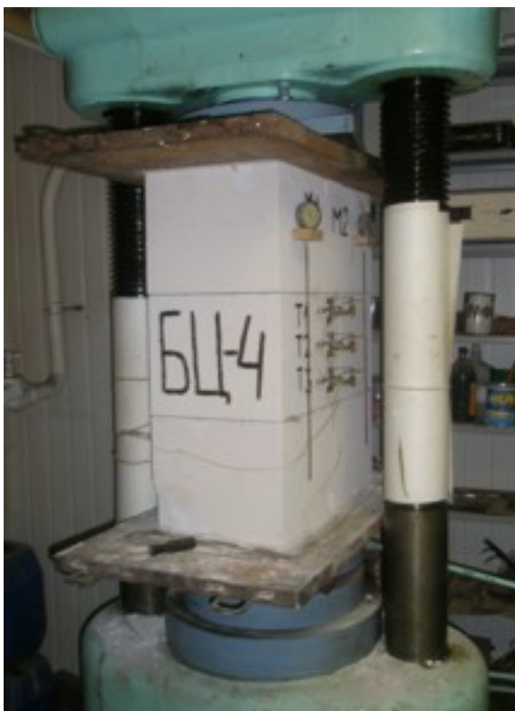
Рисунок 1 - Фрагмент кладки из газобетона марки по плотности D400, подготовленный для испытания на центральное сжатие.
