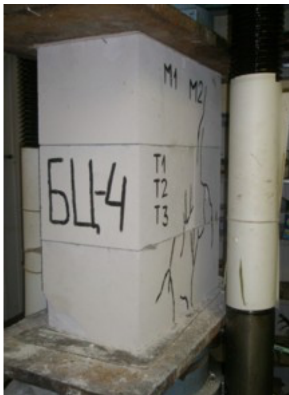
Рисунок 2 - Фрагмент кладки из газобетона марки по плотности D400 после испытания на центральное сжатие.
