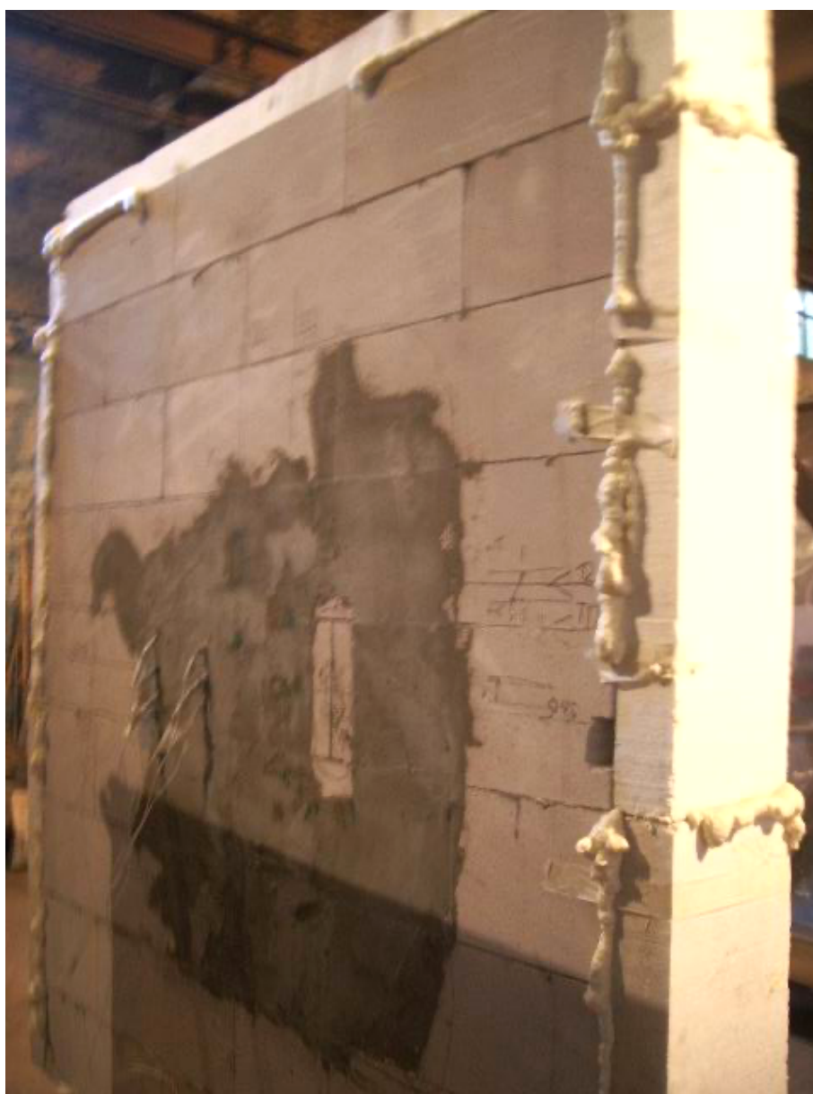
Рисунок 2 – Фрагмент стены из пазогребневых блоков «АЭРОК СПб» при проведении теплофизических испытаний.
