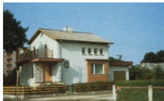
Рисунок - 2 Малоэтажный газобетонный дом с расшитыми швами без отделки
